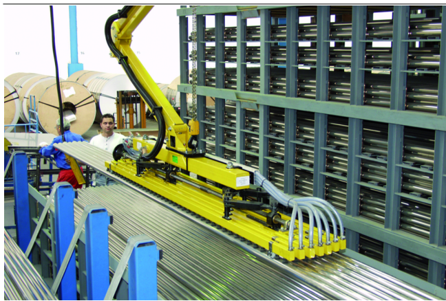
Сильфонные присоски FSGB, используемые для перемещения труб
